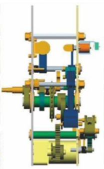
操作机构模块化设计,便于机构的更换维护。
